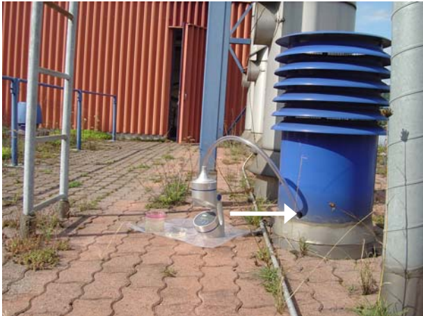
Abb. 11: Luftkeimmessung innerhalb des Ansaugstutzens
