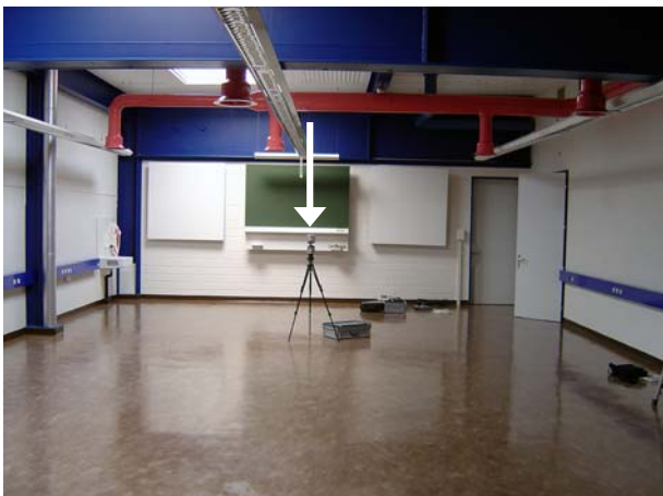
Abb. 15: Luftkeimmessung im Raum
